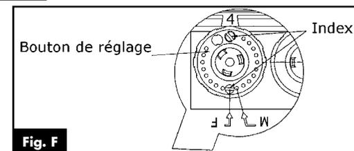
Pour obtenir le point Maxi. d'une plage de température par limitation de la rotation (exemple : de la position 0 à 7 du bouton de réglage du thermostat), placer l'index dans le trou face au repère M Fig.F.
