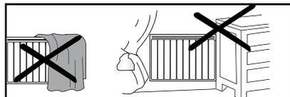
■ Si l'appareil est recouvert, il y a risque de surchauffe.
