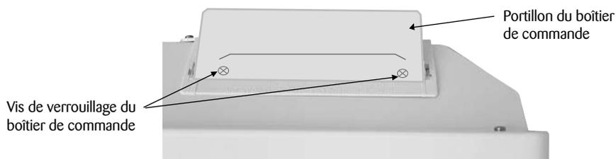
Pour accéder aux organes de commande de l'appareil, ôter (à l'aide de l'embout de vis torx fourni) les 2 vis inviolables. Puis, retirer complètement le portillon du boîtier de commande.
