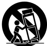
L'ensemble support-appareil doit être déplacé avec soin. Des arrêts brutaux, une force excessive et des revêtements non plans peuvent entraîner la chute de l'ensemble.
