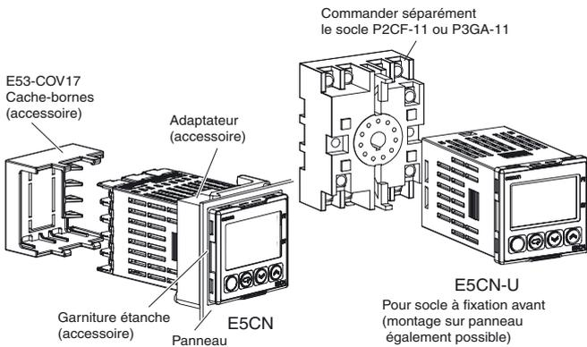
1. L'adaptateur de montage sur panneau est également compris avec le E5CN-U. Le modèle E5CN-U n'est pas doté d'une garniture étanche.
