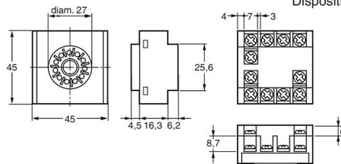
Disposition des bornes/connexions internes (vue du dessus)
