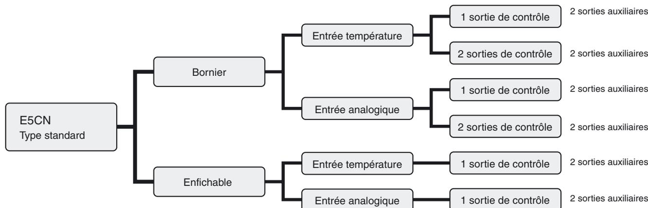
Remarque : tous les modèles peuvent être utilisés pour le contrôle Chaud, Froid et Chaud/Froid.
