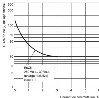
**Remarque :** ne connectez pas une charge en c.c. à un régulateur disposant d'une sortie relais à longue durée.
