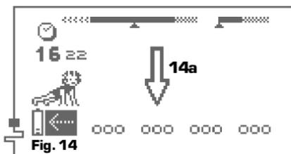
**13a-14a** Le Compex bipes et affiche alternativement le symbole d'une paire d'électrodes et celui d'une flèche pointant sur le canal qui rencontre un problème. Ci-dessus, le stimulateur a détecté un défaut d'électrodes sur le canal 2. Ce message peut signifier:
