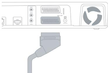
**Raccordez le décodeur à votre magnétoscope avec un cordon péritel :** branchez le cordon sur la prise péritel «VCR scart» du décodeur et sur la prise péritel «TV» de votre magnétoscope. Pour un fonctionnement optimum, ne pas brancher sur la prise péritel «Décodeur» du magnétoscope.
