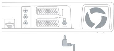
**Branchez le bloc d'alimentation électrique** sur le décodeur et branchez-le à une prise électrique.
