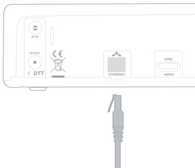
**Raccordez le décodeur à la livebox avec le câble Ethernet :**
