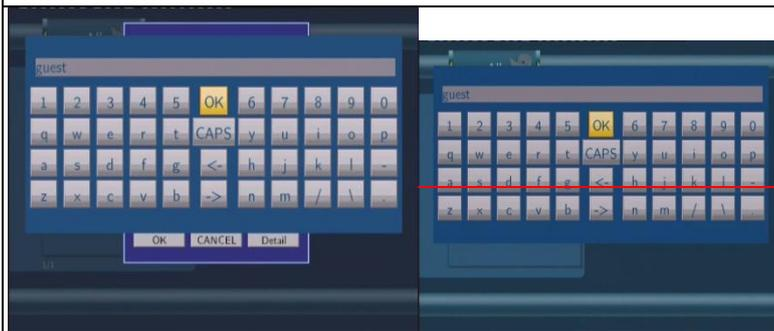
Sélectionnez l'Utilisateur ID du Réseau (Net User ID) et un clavier s'affiche. Utilisez les flèches de navigation pour sélectionner des lettres et des chiffres. Sélectionnez CAPS pour passer des lettres majuscules aux minuscules. Appuyez < - pour supprimer une lettre. Appuyez - > pour insérer un espace. Appuyez sur bouton pour entrer chaque lettre ou chiffre.
