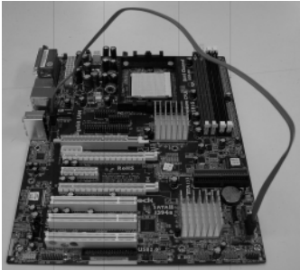
将 SATA 数据线连接 到红色的 eSATAII 接口(SATAII_BOTTOM)
