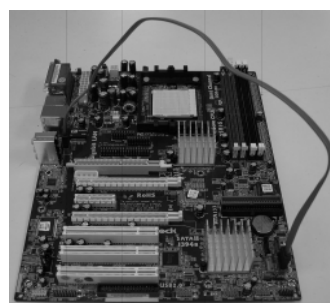
Conecte el cable de datos SATA al conector rojo eSATAII (eSATAII_ BOTTOM)
