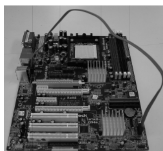
Collegare il cavo dati SATA al connettore eSATAII rosso (eSATAII_BOTTOM)
