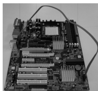
Connectez le câble de données SATA au connecteur SATAII rouge (eSATAII_BOTTOM)
