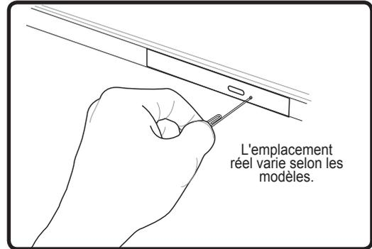
L'éjection d'urgence est située dans un trou du lecteur optique, elle est utilisée pour éjecter le tiroir du lecteur optique dans le cas où l'éjection électronique ne fonctionne pas. N'utilisez pas l'éjection d'urgence à la place de l'éjection électronique.
