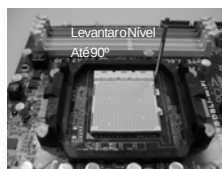
PASSO 1: Levantar o Nível de Tomada Até 90°
