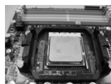
PASSO 4: Clique e Tranque o Nível de Tomada
