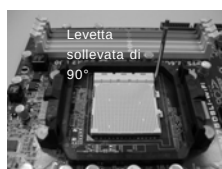
FASE 1: Sollevare la levetta socket
