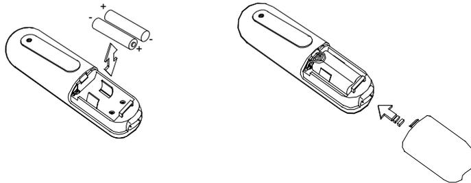
**!** *Utiliser uniquement des batteries rechargeables de caractéristiques identiques à celles fournies avec le produit. L'utilisation de piles non rechargeables ou non conformes aux modèles préconisés risque d'endommager votre produit (se référer au chapitre "Caractéristiques techniques").*
