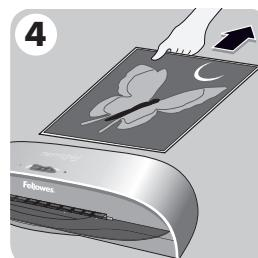
Afin d'éviter tout risque de blocage, retirer immédiatement le document plastifié, à l'arrière de la machine. Le laisser refroidir sur une surface plane pendant quelques secondes.
