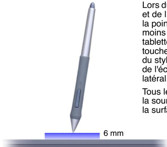
Lors du positionnement du curseur et de l'utilisation du bouton latéral, la pointe du stylet doit se trouver à moins de 6 mm de la surface de la tablette. Il n'est pas nécessaire de toucher la tablette avec la pointe du stylet pour déplacer le curseur de l'écran ou utiliser le bouton latéral.
