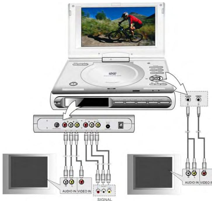
Après la connexion à une source AV externe par les prises AV, mettez l'unité sous tension et appuyez sur la touche SOURCE sur le panneau avant pour passer en mode AV1 ou appuyez sur la touche AV1 de la télécommande pour changer directement de mode.
