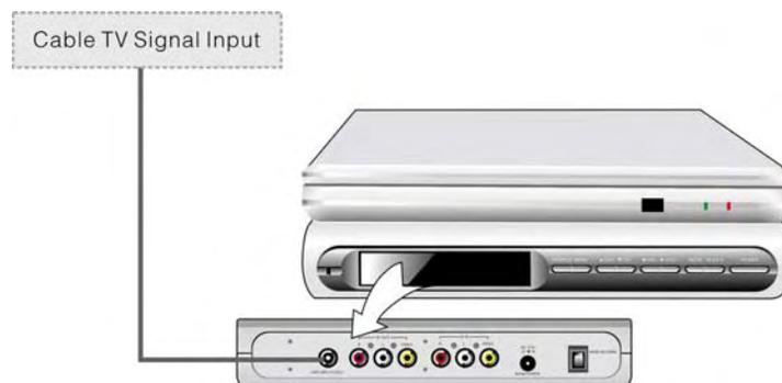
Après avoir connecté l'antenne, mettez la station d'accueil sous tension ; appuyez sur la touche SOURCE du panneau avant ou sur la touche TV de la télécommande pour passer au mode TV.
