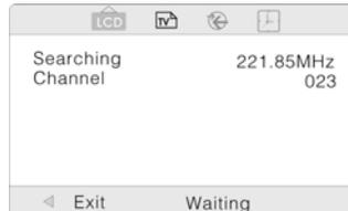
La fonction de mémorisation automatique prendra quelques minutes. L'appareil effectuera une recherche de canaux dans la liste de canaux standard, du canal le plus bas au canal le plus élevé. Lorsque les opérations de syntonisation sont terminées, l'appareil arrête la recherche et enregistre un à un les canaux dans la mémoire. Pendant la syntonisation, appuyez sur la touche ◀ pour quitter la mémorisation automatique.
