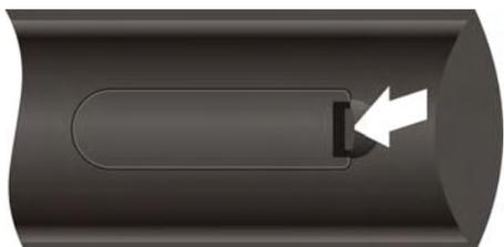
Insérez deux piles (1,5 V taille AAA) en veillant à respecter les repères de polarité à l'intérieur du compartiment.
