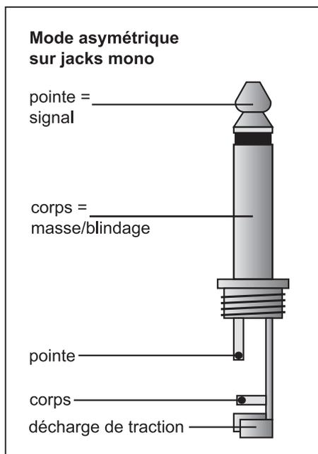
Fig. 3.1: Câblage d'une fiche de jack mono
