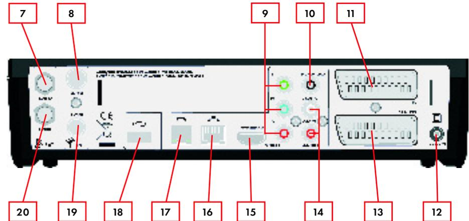
**7 ENTREE ANTENNE SATELLITE****8 ENTREE ANTENNE TNT****9 PRISES VIDEO ANALOGIQUE Y Pb Pr****10 PRISE AUDIO NUMERIQUE****11 PRISE PERITEL (vers téléviseur)****12 PRISE DE RACCORDEMENT DU BLOC D'ALIMENTATION 12V****13 PRISE PERITEL (vers magnétoscope ou graveur DVD de salon)****14 PRISES AUDIO ANALOGIQUE (vers chaînes HI-FI)****15 PRISE AUDIO/VIDEO NUMERIQUE HDMI****16 PRISE ETHERNET\*\*****17 PRISE TELEPHONIQUE****18 PRISE USB\*\*****19 SORTIE ANTENNE TNT****20 SORTIE ANTENNE SATELLITE\***
