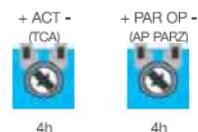
A la fin de l'installation, régler finement les Trimmers (316)
