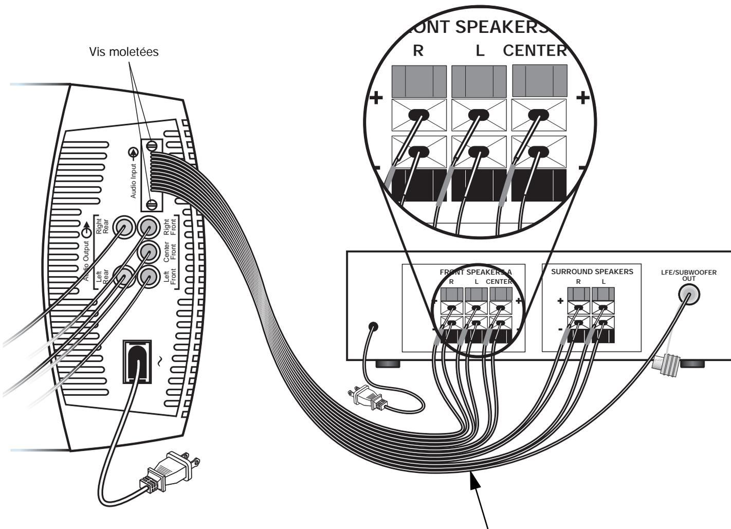
♪ **Remarque :** Les paires de conducteurs du câble peuvent être séparées de manière à se conformer plus facilement aux exigences de raccordement de l'amplificateur.
