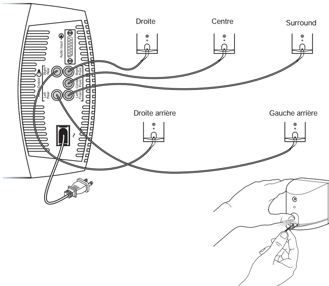
1. Raccordez la paire de conducteurs repérée **CENTER** (centre) à l'enceinte cube centrale (Figure 5). Pressez le poussoir de la borne de raccordement située à l'arrière de l'enceinte. Insérez le conducteur repéré (+) dans la borne rouge et l'autre conducteur (-) dans la borne noire. Relâchez le poussoir pour verrouiller les conducteurs.
