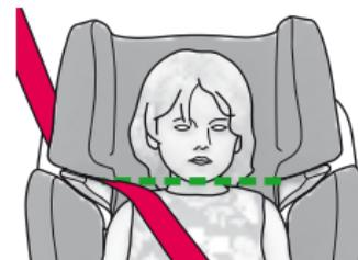
Le passant de la sangle d'épaule (06) doit être positionné un peu plus haut que le bord supérieur de l'épaule. La sangle d'épaule doit par ailleurs passer au milieu entre le cou et le bord extérieur de l'épaule.
