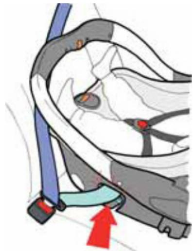
La partie de la ceinture d'épaules de la voiture doit être passée derrière le siège auto.
