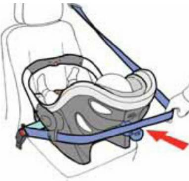
Diesen Teil des Gurts spannen und Blockierklammer (02) schließen. Anschließend noch einmal die sichere Befestigung des Sitzes überprüfen.
