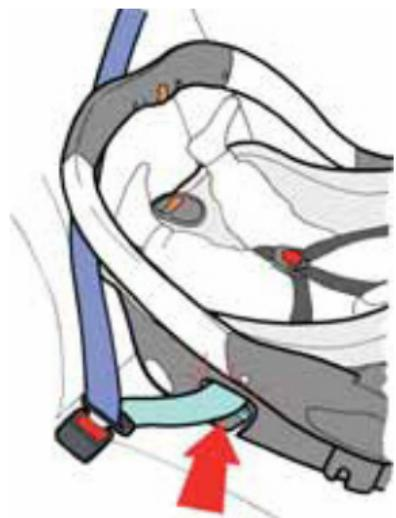
La parte della cinghia spalla della cintura di sicurezza dell'automobile dovrà passare dietro il seggiolino.
