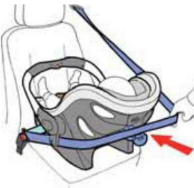
Tendere tale parte della cintura di sicurezza e chiudere la pinza di bloccaggio (**02**). Assicurarsi che il seggiolino sia fissato saldamente, tirando.
