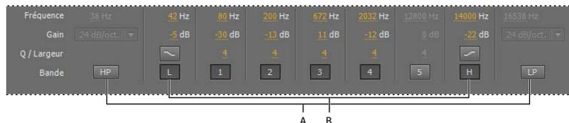
Identification des filtres passe-bande et d'atténuation dans l'Égaliseur paramétrique :
