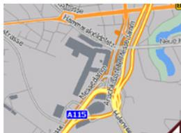
Si la navigation n'est pas active, pratiquement toute la surface de l'écran tactile est occupée par la représentation de la carte. A côté de celle-ci, dans le coin inférieur droit, il y a toujours une icône qui permet d'accéder au mode Réglage avec la barre d'outils.
