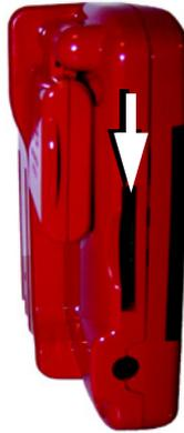
Sur le côté gauche de l'appareil se trouve le logement de la carte. Le logement de la carte est équipé d'un mécanisme d'encliquetage et d'éjection à ressort.
