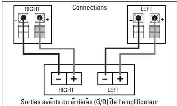
Les haut-parleurs et les bornes électroniques ont des bornes (+) et (-) qui correspondent. Il est important de relier les deux haut-parleurs de façon identique: le (+) du haut-parleur relié au (+) de l'amplificateur et le (-) du haut-parleur au (-) de l'amplificateur. Un câblage déphasé produit un son faible, des basses amoindries et une image stéréo faible.
