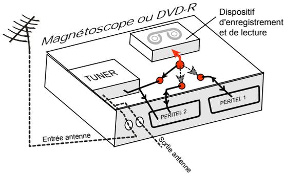
La sortie antenne de votre enregistreur (magnétoscope ou DVD-R) permet de brancher en cascade l'entrée antenne de votre téléviseur. Vous pouvez choisir manuellement la chaîne que vous souhaitez enregistrer, mais également choisir d'enregistrer l'appareil branché sur la PERITEL 1 ou la PERITEL 2.
