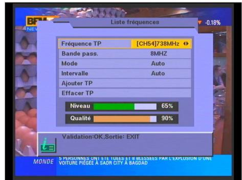
Le niveau et la qualité de réception affichés sont ceux du canal de fréquence TNT couramment sélectionné sur la ligne «Fréquence TP».
