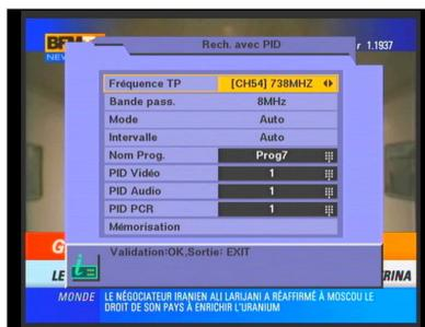
Sélectionnez le canal (Fréquence TP) à l'aide des touches "◀▶" ou pressez sur la touche "OK" pour afficher la liste des canaux. Entrez la valeur du PID Vidéo puis cliquez sur "OK". Faire de même pour les PID Audio et PCR. En général, le PID VCR est identique au PID Vidéo. Vous pouvez modifier le nom du programme en positionnant le curseur sur «Nom Prog.» et en cliquant sur "OK".
