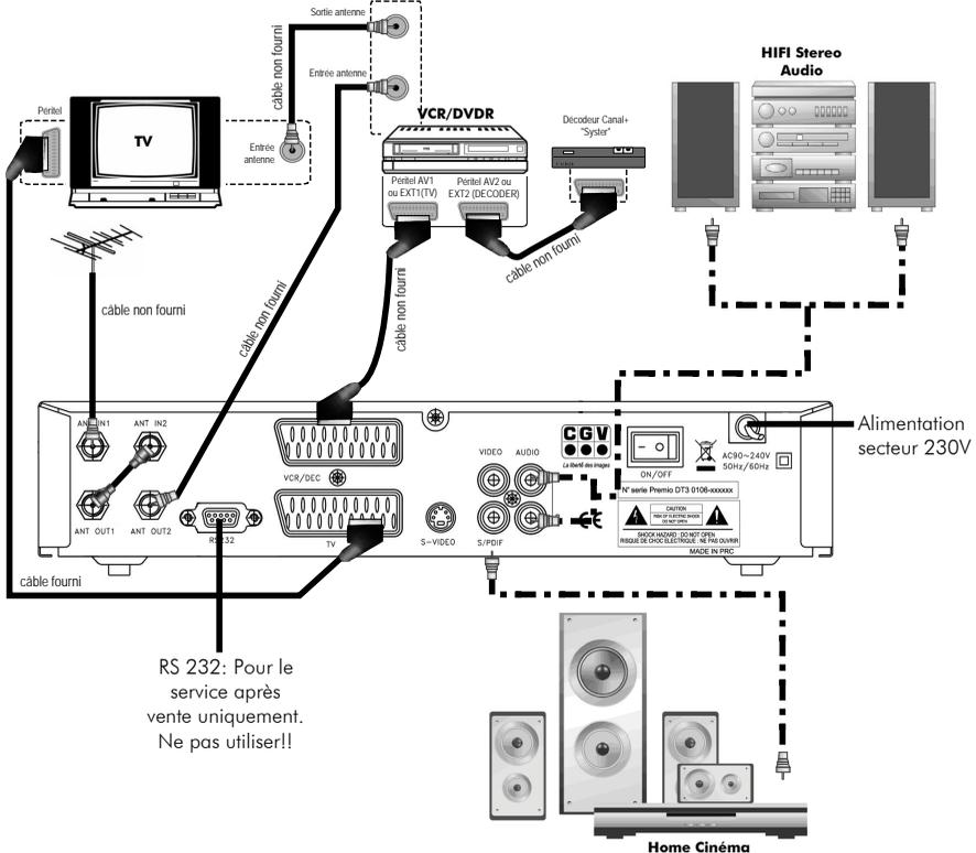
Entrée «ANT IN 1» : A connecter à votre antenne «râteau» ou à votre antenne intérieure.
