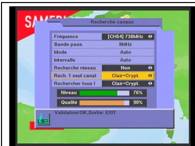
**Attention :** dans l'écran de configuration «Installation», «Recherche des canaux» les paramètres «Rech. 1 seul canal» et «Rechercher tous» sont également des options qui vous permettront de lancer une recherche des canaux sur une ou sur toutes les fréquences, respectivement.
