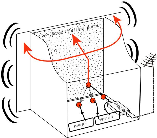
Le tuner est la partie du téléviseur sur laquelle vous branchez l'antenne et qui reçoit les programmes TV analogiques. Le tuner du TV ne permet pas de recevoir les programmes TNT. Par défaut l'écran et les hauts parleurs diffusent le signal reçu par le tuner du TV.
