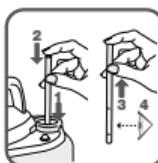
Contenance 0,8 l. Contrôler le niveau d'eau avec la jauge hydrométrique. Après avoir inséré la jauge dans le réservoir (1), obturez-la avec un doigt (2) et retirez-la (3).
