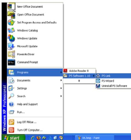
**PS-Link** démarre ensuite et recherche automatiquement tous les serveurs d'impression présents sur le même segment du réseau. Si l'installation a réussi, le nom de votre serveur d'impression apparaît dans la colonne **Server Name (Nom du serveur)**. Si votre serveur d'impression n'apparaît pas, veuillez vérifier la connectivité de votre réseau avant de cliquer à nouveau sur le bouton **Discover (Rechercher)**.
