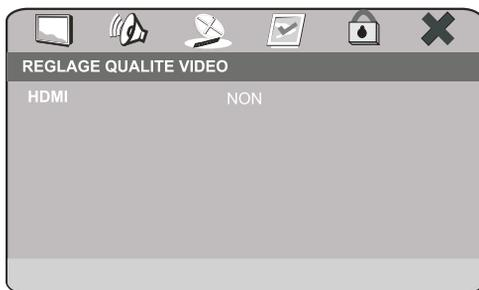
**HDMI** : Permet d'activer la sortie HDMI.
