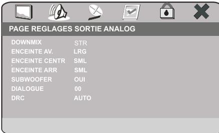
**DOWNMIX** : Permet de régler le mode de sortie audio.
