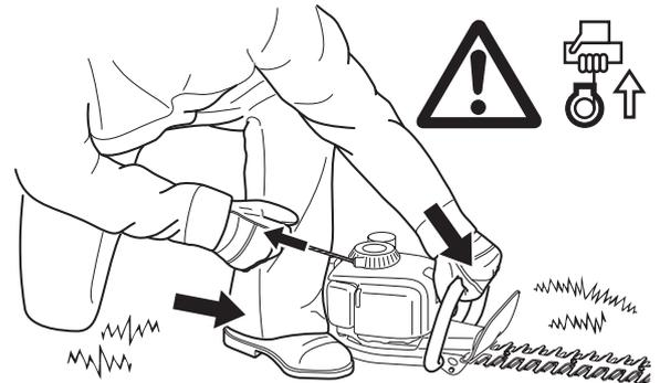
che de verrouillage de sécurité n'est pas actionnée, ne travailler en aucun cas avec l'appareil. Visiter dans ce cas un atelier de réparation DOLMAR!
