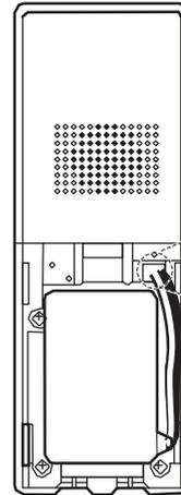
**B.** Brancher le connecteur de batteries en haut du compartiment.
