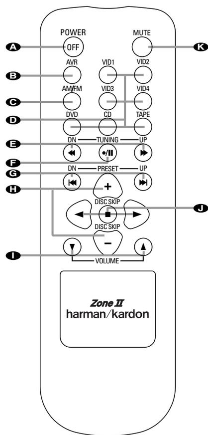
Ta télécommande de la zone II peut être utilisée soit dans la même pièce que le DPR, soit dans une pièce séparée avec un capteur infrarouge en option qui sera branché sur la prise entrée infrarouge multi-room de l'appareil 25.
