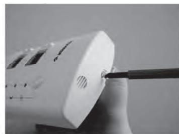
3/ Introduzca un destornillador de punta plana en el talón al lado del tornillo y haga palanca para abrir la caja mural. Separe la parte fachada de la parte zócalo.
