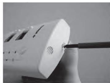
3/ Insira uma chave de fendas com ponta plana no calcanhar ao lado do parafuso e serve-se como de uma alavaca se tratasse para abrir a caixa mural. Separe a parte fachada da parte base.
