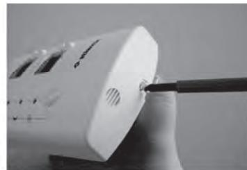
3/Insérez un tournevis à bout plat dans le talon à côté de la vis, et faites levier pour ouvrir le boîtier mural. Séparez la partie façade de la partie socle.
