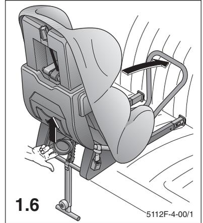
Legen Sie die Unterteile der Spanngurte um ein Befestigungsrohr des Vordersitzes möglichst nah am Fahrzeugboden. Fädeln Sie die Gurtschlosshälften durch die Schlaufen und ziehen Sie diese fest.
