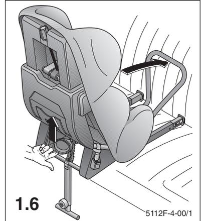
Disposez les parties inférieures des sangles autour d'un tube de fixation du siège avant, si possible à proximité du sol. Enfilez les deux moitiés de la serrure de la ceinture à travers les boucles et tendez-les.
