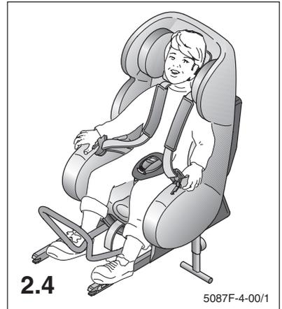
Fermez la serrure en superposant les deux languettes (1) et en les introduisant dans la serrure avec un déclic audible (2).
