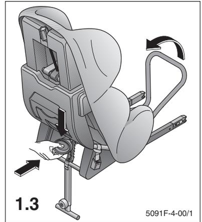
Stecken Sie die Isofixkonnektoren in die Einführhilfen, bis sie einrasten; dabei muss die grüne Markierung am Konnektor sichtbar werden. Prüfen Sie die Verrastung durch beidseitiges Ziehen an den Isofixholmen.
