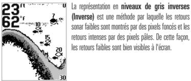
La représentation en **niveaux de gris inverses (Inverse)** est une méthode par laquelle les retours sonar faibles sont montrés par des pixels foncés et les retours intenses par des pixels pâles. De cette façon, les retours faibles sont bien visibles à l'écran.
