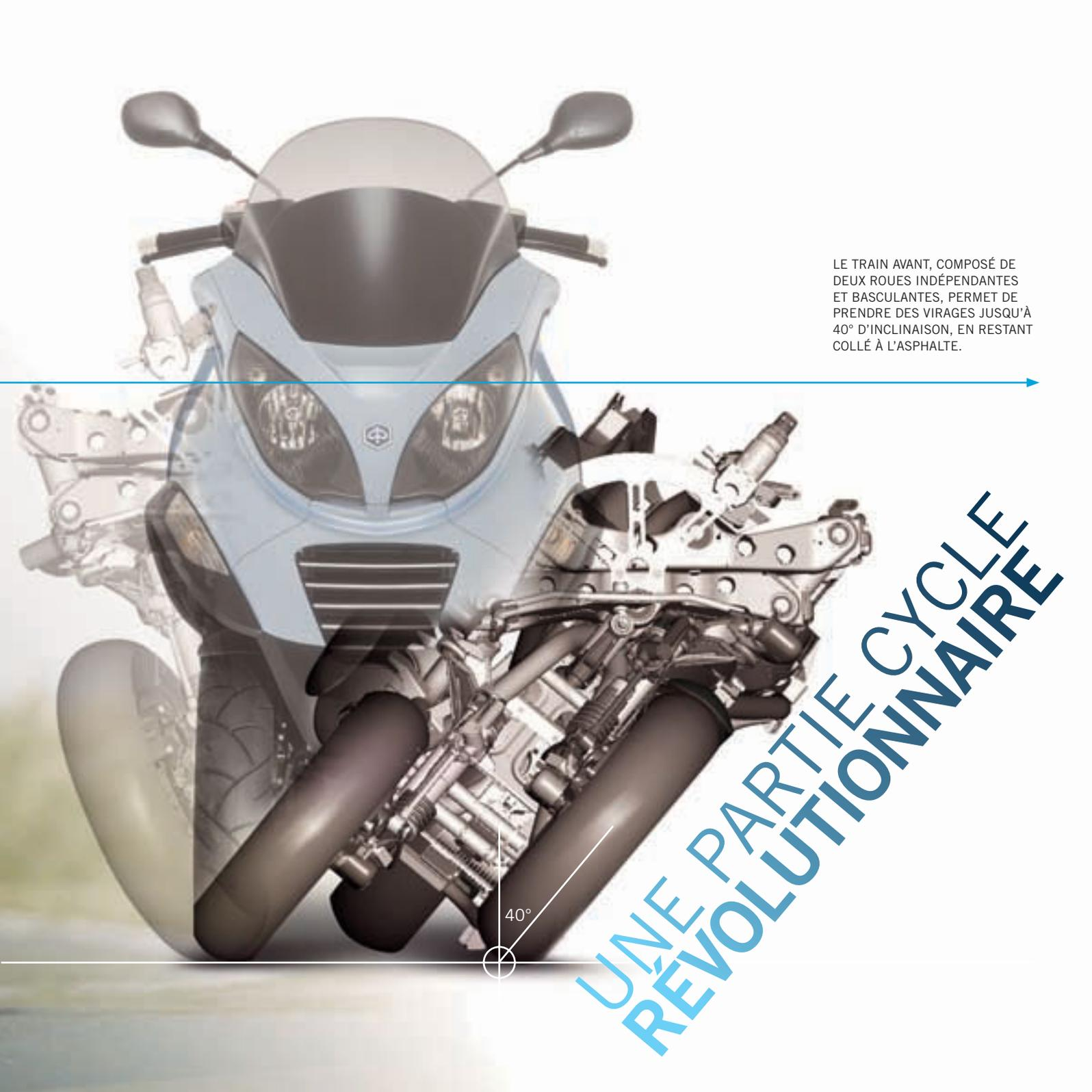
LE TRAIN AVANT, COMPOSÉ DE DEUX ROUES INDÉPENDANTES ET BASCULANTES, PERMET DE PRENDRE DES VIRAGES JUSQU'À 40° D'INCLINAISON, EN RESTANT COLLÉ À L'ASPHALTE.
