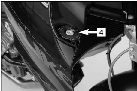
Le liquide de refroidissement est composé de 50% d'antigel et 50% d'eau distillée. Il est nécessaire qu'il assure une protection jusqu'à -25°C. Acôté de sa protection contre le gel, ce liquide est efficace aussi contre la corrosion, c'est pourquoi il ne faut pas le remplacer simplement par de l'eau.
