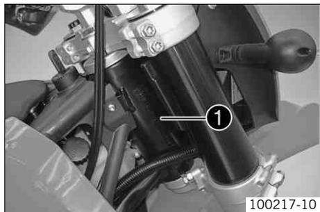
Le numéro de châssis ❶ est gravé à droite sur la tête de direction.
