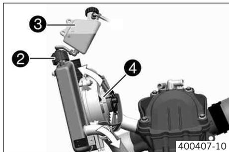
Le refroidissement s'effectue par vent relatif et par ventilateur de refroidissement ④ commandé par thermocontact.
