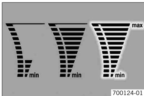
L'indicateur de température à l'écran se compose de 12 barres. Plus le nombre de barres allumées est important, plus le liquide de refroidissement est chaud. Lorsque la barre supérieure s'allume, toutes les barres se mettent à clignoter simultanément et la lampe-témoin de température s'allume.
