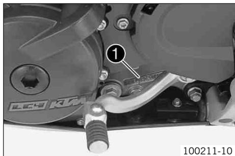
Le numéro de moteur ❶ est frappé à froid sur le côté gauche du moteur, sous le pignon de chaîne.
