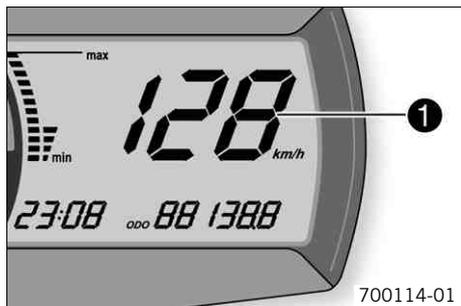
La vitesse ① est affichée en kilomètres par heure **km/h** ou en miles par heure **Mph**.
