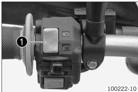
Le contacteur de l'éclairage ❶ se trouve sur le côté gauche du guidon.
