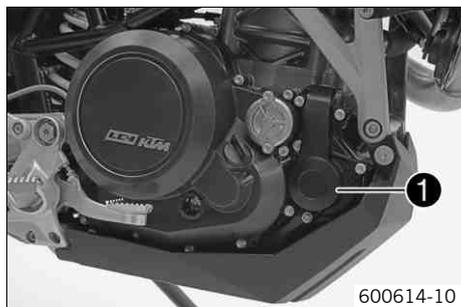
La pompe à eau ① provoque une circulation forcée du liquide de refroidissement dans le moteur.
