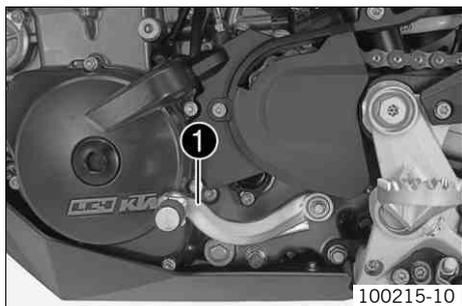
Le sélecteur ❶ est installé sur le côté gauche du moteur.
