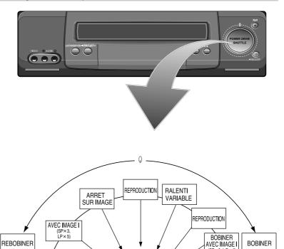
En tournant le bouton du changeur à droit en mode stop, la cassette avance rapidement à une vitesse très élevée sans image ni son (avance rapide). En tournant le bouton du changeur à gauche en mode stop, la cassette se rembobine rapidement à une vitesse très élevée sans image ni son (rembobinage).
