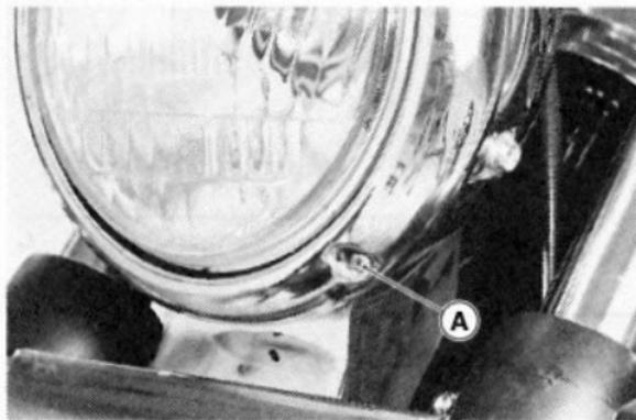
A. Vis de réglage vertical du faisceau
