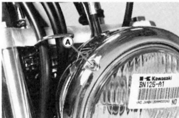
A. Vis de réglage horizontal du faisceau
