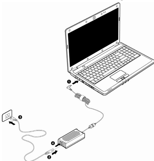
L'adaptateur dispose d'un interrupteur marche/arrêt. Si l'interrupteur se trouve sur la position ARRÊT (**0**), l'adaptateur ne consomme pas de courant et l'ordinateur portable n'est pas alimenté.
