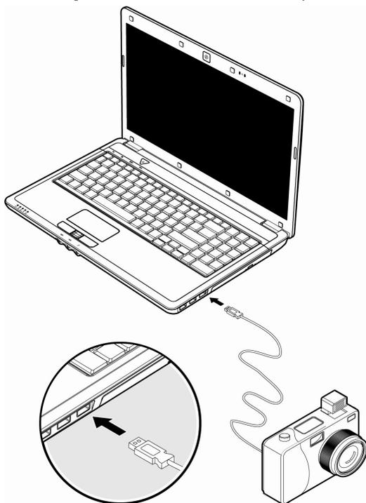
On ne peut pas exiger plus de 500 mA d'un appareil connecté directement au bus USB. Si les appareils ont besoin d'une puissance plus élevée, l'installation d'un distributeur / amplificateur est nécessaire.
