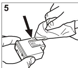
5. Nettoyez les contacts électriques à l'aide d'un chiffon légèrement humide.
