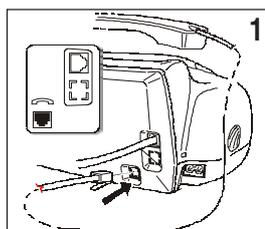
1. Insérez le connecteur du câble du combiné dans la prise correspondante du télécopieur (caractérisée par le symbole ☞).
