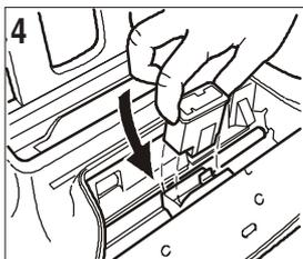
4. Insérez la tête dans le logement, avec les contacts électriques orientés vers le bas.
