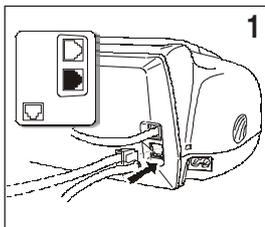
1. Pour connecter le téléphone d'urgence directement au télécopieur, retirez le couvercle protégeant la prise de connexion à la ligne externe, et insérez ensuite le connecteur du téléphone d'urgence dans cette prise.
