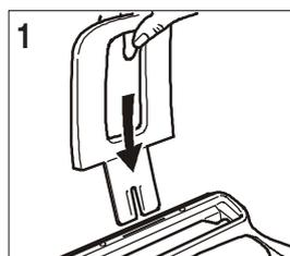
1. Insérez le support pour le papier d'impression dans la fente correspondante, et poussez-le jusqu'à ce qu'il s'enclenche en position.
