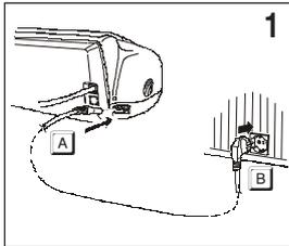
1. A. Raccordez la fiche située à une extrémité du câble d'alimentation électrique au connecteur placé sur le côté arrière de l'appareil.
