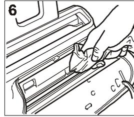
6. Nettoyez le miroir du lecteur optique avec un **chiffon imbibé** d'un produit de nettoyage pour les vitres, puis essuyez-le soigneusement.
