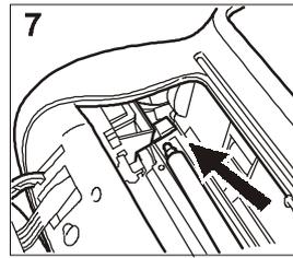
7. Placez une extrémité du rouleau sur le pivot situé sur la gauche du télécopieur, comme indiqué par la flèche.
