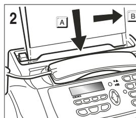
2. A. Insérez l'original dans le dispositif d'introduction, avec le côté à émettre orienté vers le bas.
