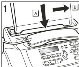
1. A. Insérez l'original dans le dispositif d'introduction, avec le côté à émettre orienté vers le bas.
