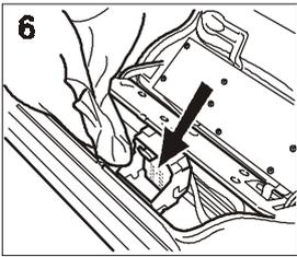
6. Nettoyez également avec un chiffon légèrement humide les contacts électriques du chariot porte-tête.
