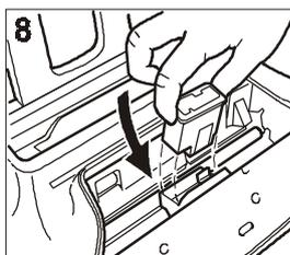
8. Insérez la tête neuve dans le logement, avec les contacts électriques orientés vers le bas.
