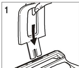
1. Insérez le support pour le papier d'impression dans la fente correspondante, et poussez-le jusqu'à ce qu'il s'enclenche en position.
