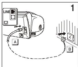
1. A. Insérez le connecteur "miniature" (transparent) du câble de connexion à la ligne téléphonique dans la prise "LINE" située sur le côté arrière du télécopieur.
