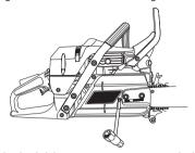
De ketting is juist gespannen wanneer ze niet langer slap hangt aan de onderkant van het zaagblad en toch gemakkelijk met de hand kan worden voortbewogen. Hou de tip van het blad omhoog en draai de zaagbladmoeren met de combisleutel vast.
