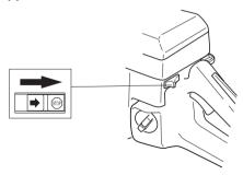
De motor wordt stopgezet, door de ontsteking met behulp van de stopschakelaar uit te schakelen.
