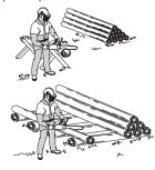
Le tronc est couché à même le sol. Il n'y a aucun risque de coinçage de la chaîne ou de fendage de la pièce à scier. Par contre, il existe un risque important que la chaîne rencontre le sol après le sciage.
