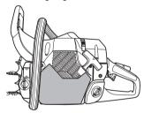
N.B.! Indien een speciale winterset is gemonteerd of er maatregelen getroffen zijn om de motortemperatuur te verhogen, moet de afstelling weer worden aangepast als de machine onder normale omstandigheden wordt gebruikt. Anders is er risico op oververhitting, waardoor de motor ernstig beschadigd kan worden.
