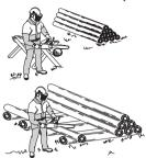
**De stam ligt op de grond.** Er bestaat geen risico dat de ketting wordt vastgeklemd of dat de stam splijt. Het risico dat de ketting na het doorzagen de grond raakt, is echter wel groot.
