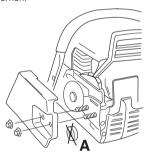
Die Schiene über die Schienenbolzen montieren. Die Schiene in der hintersten Position aufsetzen. Die Kette um das Kettenantriebsrad und in die Schienennut legen. Auf der Oberseite der Schiene beginnen.
