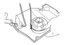
Déposer la vis au centre de la poulie et enlever la poulie. Installer et bloquer une nouvelle corde sur la poulie. Enrouler la corde d'environ 3 tours sur la poulie. Monter la poulie contre le ressort de rappel, de manière à ce que l'extrémité du ressort s'engage dans la poulie. Reposer la vis dans le centre de la poulie. Passer la corde à travers le trou du boîtier du lanceur et dans la poignée. Faire un nœud robuste à l'extrémité de la corde.
