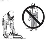
Die Motorsäge stets mit beiden Händen halten. Mit der rechten Hand den hinteren Griff und mit der linken den vorderen Griff umfassen. Alle Benutzer, ob Links- oder Rechtshänder, müssen die Handgriffe so greifen. Fest umfassen, sodass Daumen und Finger den Handgriff umschließen.
