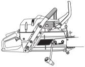
La chaîne est tendue correctement quand elle ne pend plus sous le guide et peut être avancée à la main sans difficulté. Serrer les écrous du guide à l'aide de la clé universelle tout en maintenant levé le pignon du guide.
