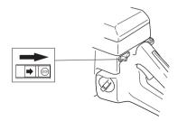
Der Motor wird durch Ausschalten der Zündung mit dem Stoppschalter abgestellt.
