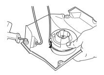
Die Schraube in der Mitte der Seilrolle lösen und die Rolle entfernen. Ein neues Startseil einziehen und in der Rolle befestigen. Etwa 3 Wicklungen um die Seilrolle legen. Die Seilrolle so gegen die Rückzugfeder montieren, dass das Ende der Rückzugfeder in der Seilrolle eingehakt ist. Die Schraube in der Mitte der Seilrolle montieren. Das Startseil durch die Löcher in Startergehäuse und Startgriff ziehen. Dann das Seil mit einem festen Knoten sichern.
