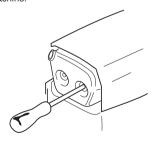
Bepaalde geluiddempers zijn voorzien van een speciaal vonkenopvangnet. Indien uw machine uitgerust is met zo'n geluiddemper, moet u het net minstens één keer per week schoonmaken. Gebruik bij voorkeur een stalen borstel. Een verstopt net leidt tot oververhitting van de motor wat tot ernstige beschadigingen van de motor leidt.
