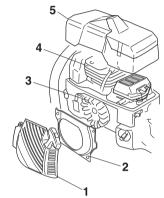
Das Kühlsystem einmal pro Woche mit einer Bürste reinigen, bei schwierigen Verhältnissen öfter. Eine Verschmutzung oder Verstopfung des Kühlsystems führt zur Überhitzung des Gerätes, die Schäden an Zylinder und Kolben zur Folge haben kann.
