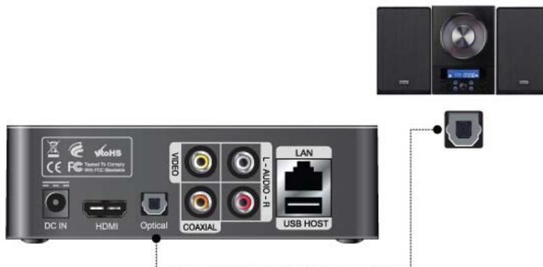
Si vous possédez un décodeur/amplificateur multicanaux avec une entrée optique, vous pouvez obtenir un son 5.1CH de grande qualité via le câble optique. L'image ci-dessus montre comment brancher le câble optique.
