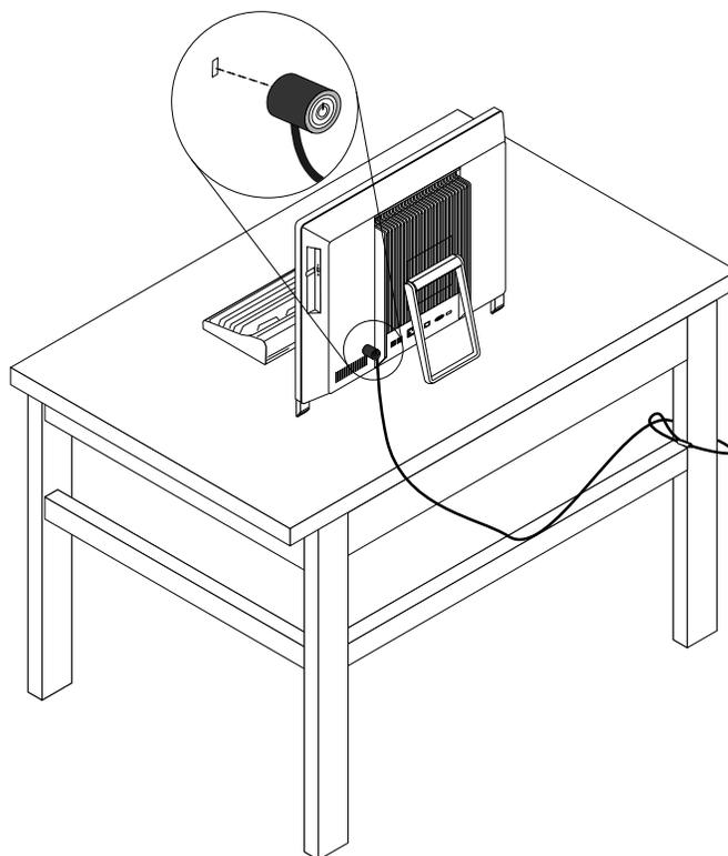
Figure 5. Verrou de câble intégré
