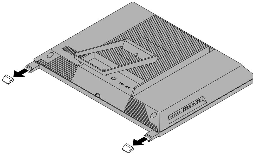
Figure 11. Retrait du support en caoutchouc sur chaque pied
