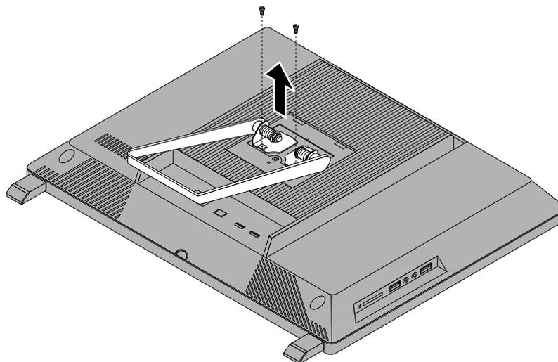
Figure 9. Retrait du socle du système
