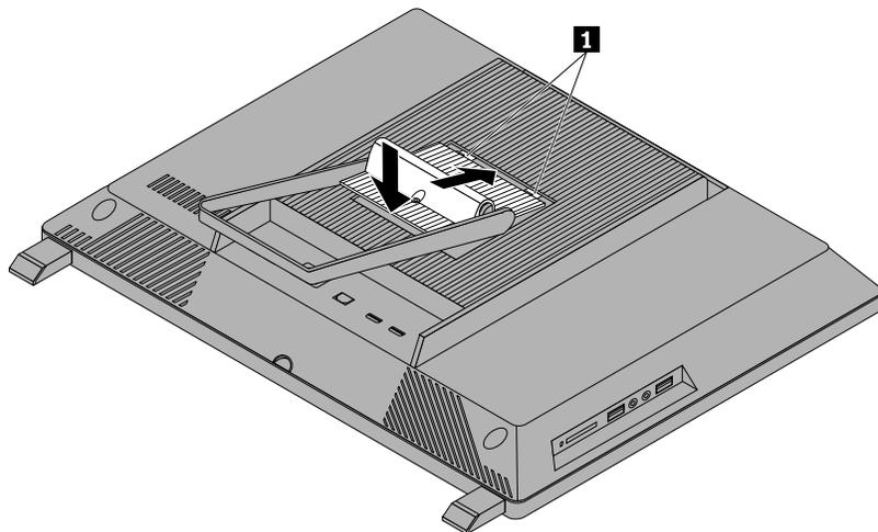
Figure 7. Réinstallation du couvercle à charnière du socle du système
