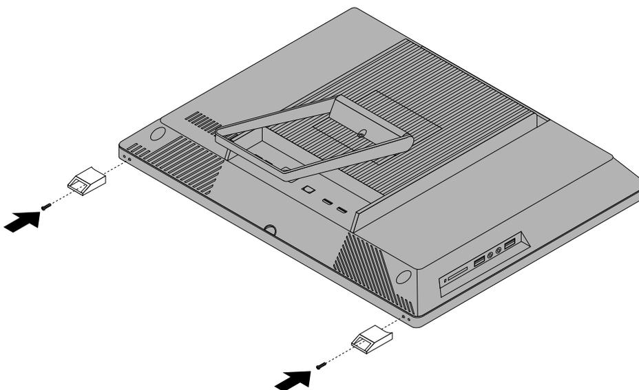
Figure 13. Réinstallation de chaque pied sur l'ordinateur
