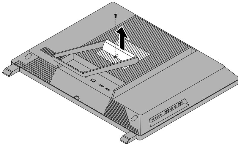
Figure 6. Retrait du couvercle à charnière du socle du système
