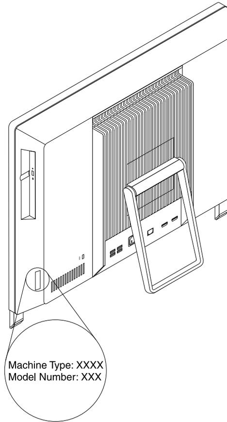
Figure 4. Etiquette d'indication du type et modèle de machine
