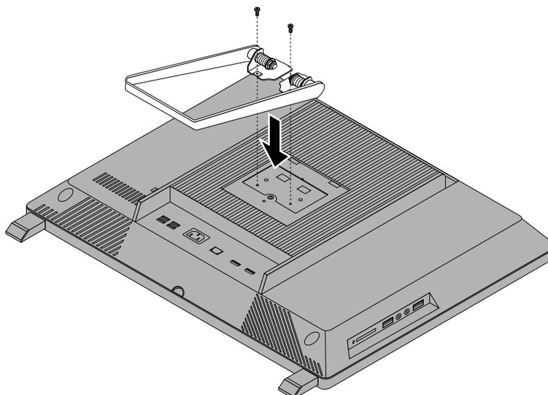
Figure 10. Réinstallation du socle du système
