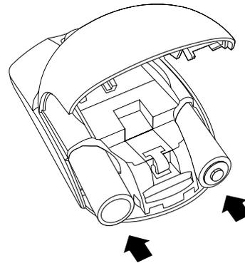
5. Fermez le capot du compartiment de la batterie de la souris et faites-le glisser vers l'avant pour le remettre en place.
