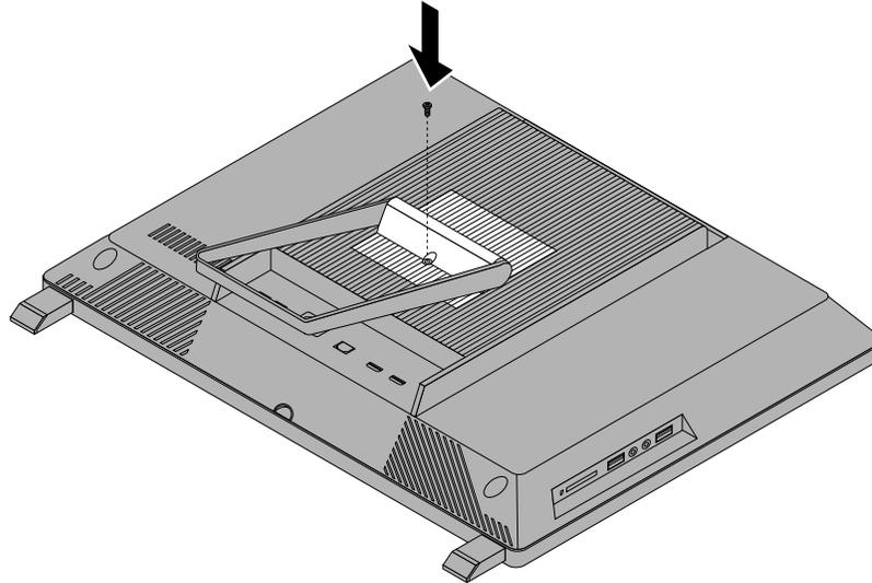
Figure 8. Réinstallation de la vis pour fixer le couvercle à charnière du socle du système sur l'ordinateur
