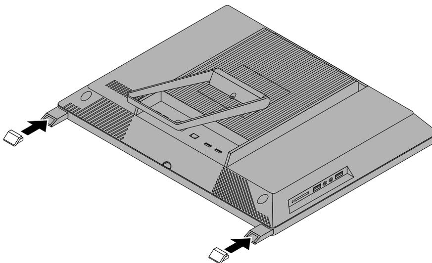
Figure 14. Réinstallation du support en caoutchouc sur chaque pied
