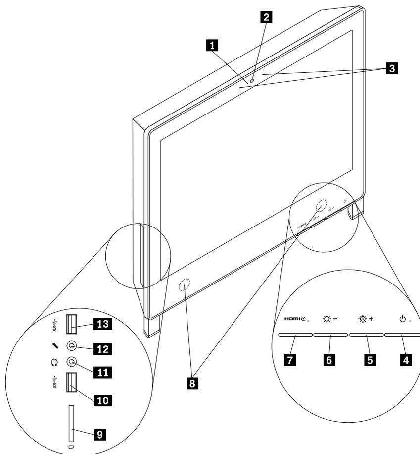
Figure 1. Emplacement des connecteurs, des boutons de commande et des voyants à l'avant
