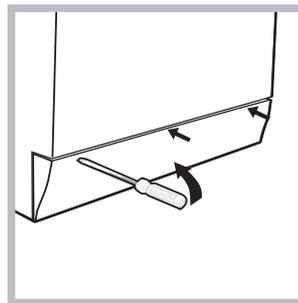
1. démonter le panneau situé à l'avant du lave-linge à l'aide d'un tournevis (voir figure);
