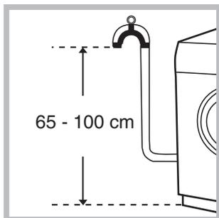
Raccorder le tuyau de vidange à un conduit d'évacuation ou à une évacuation murale placés à une distance du sol comprise entre 65 et 100 cm en évitant à tout prix de le plier.
