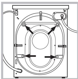
2. Enlever les quatre vis de protection pour le transport et la cale, placés dans la partie arrière (voir figure).
