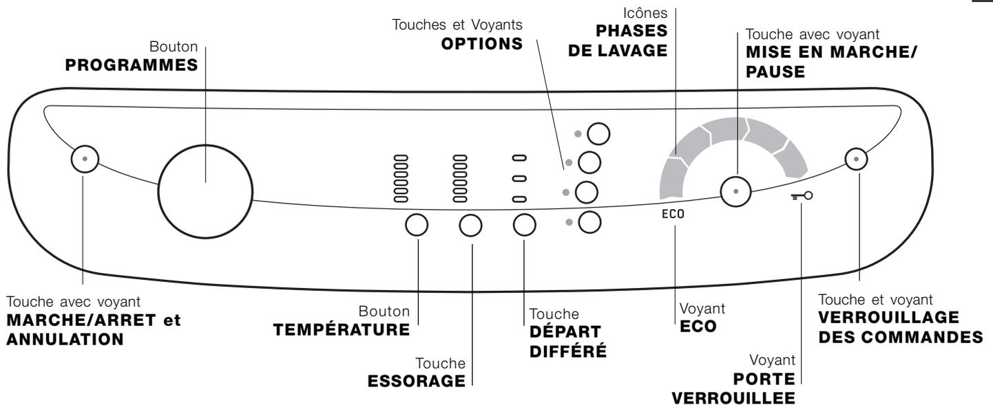
Touche avec voyant **MARCHE/ARRÊT et ANNULATION:** appuyer brièvement sur la touche pour allumer ou éteindre l'appareil. Le témoin vert indique que l'appareil est sous tension. Pour éteindre le lave-linge en cours de lavage, appuyer sur la touche pendant au moins 2 secondes de suite; une pression brève ou accidentelle n'entraîne pas l'arrêt de l'appareil. L'arrêt de l'appareil pendant un lavage annule le lavage en cours.
