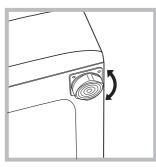
2. Pour compenser les irrégularités du sol, visser ou dévisser les pieds de réglage jusqu'à ce que l'appareil soit parfaitement à l'horizontale (il ne doit pas être incliné de plus de 2 degrés).
