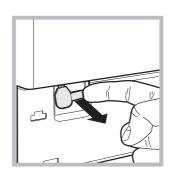
4. se servir de la languette indiquée, tirer vers soi jusqu'à ce que le tirant en plastique se dégage de son cran d'arrêt; tirer ensuite vers le bas jusqu'à ce qu'un "clic" indique que la porte est déverrouillée.
