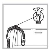
Autrement, accrocher le tuyau de vidange à un évier ou à une baignoire, dans ce cas, fixer le support plastique fourni avec l'appareil au robinet (voir figure).
