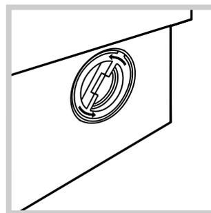
2. dévissez le couvercle en le faisant tourner dans le sens inverse des aiguilles d'une montre (voir figure): il est normal qu'un peu d'eau s'écoule;
