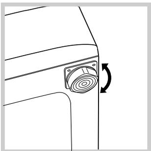
2. Si le sol n'est pas parfaitement horizontal, vissez ou dévissez les petits pieds avant (voir figure) pour niveler l'appareil; son angle d'inclinaison, mesuré sur le plan de travail, ne doit pas dépasser 2°.
