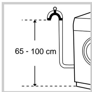
Raccordez le tuyau d'évacuation, sans le plier, à un conduit d'évacuation ou à une évacuation murale placés à une distance du sol comprise entre 65 et 100 cm;
