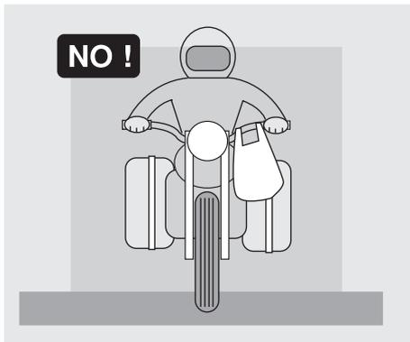
Ne jamais fixer d'objets encombrants, volumineux, lourds et/ou dangereux sur le guidon, les garde-boues et les fourches; cela pourrait ralentir la réponse du véhicule en virage et compromettre inévitablement sa maniabilité.
