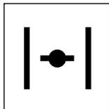
Levier starter fermé (démarrage à froid)
