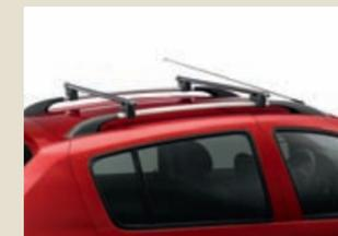
Les barres de toit transversales sur longitudinales permettent de transporter 80 kg de bagages ou d'installer d'autres accessoires de loisirs.
